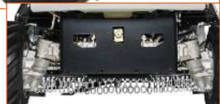
L'opérateur enclenche la lame simplement en appuyant sur le **bouton de commande de l'embrayage électromagnétique** (fig.a).
