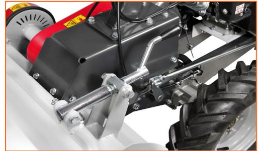
**Guidon réglable en hauteur et en déport** permettant de s'adapter facilement à la taille de l'utilisateur.
